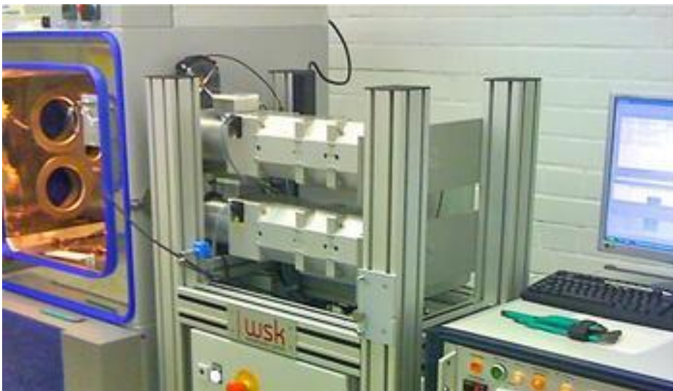
Sensor Run-In und Kalibrierung mit Klimasimulation.
